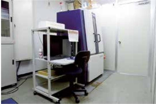
図1：X線回折装置（Ultima IV，リガク）
