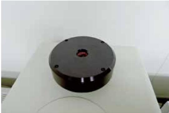
図9：顕微システムの液体窒素注入口
