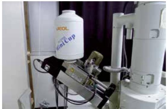
図4：エネルギー分散型蛍光X線分析器（JED-2201，日本電子）
