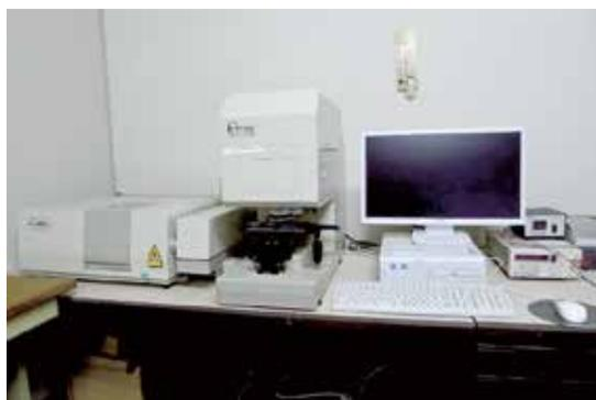
図7：フーリエ変換赤外分光光度計（FT/IR-460 plus, 日本分光）
