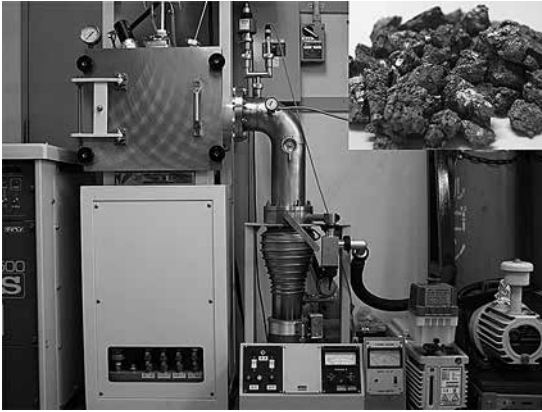
図2 アーク溶解炉とスポンジチタン (右上)
