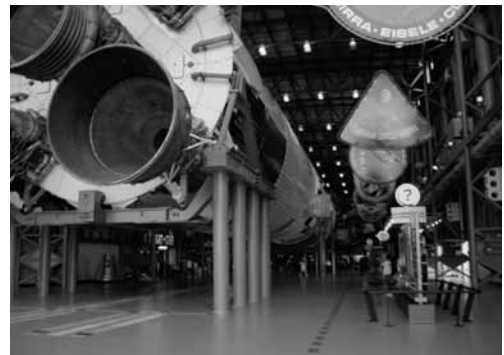
図2 アポロ計画で打ち上げ使用されたサターンVロケット。月にアポロ月探査司令船、機械船、月着陸船(LM)を送り込むために開発されたロケット。全長110mにおよぶ史上最大のロケット。
