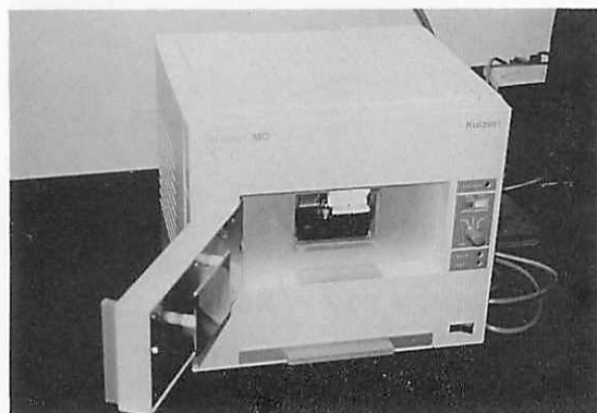
図 8. シリコーター MD 接着用表面処理装置
