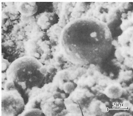
図11 レジン維持装置としての溶射膜の走査電顕像
