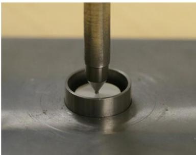
図3 歯科用ジルコニアの2軸曲げ試験
