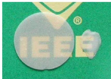
図6 エナメル質（右）の光学特性に近似させた試作コンポジットレジン（左）
